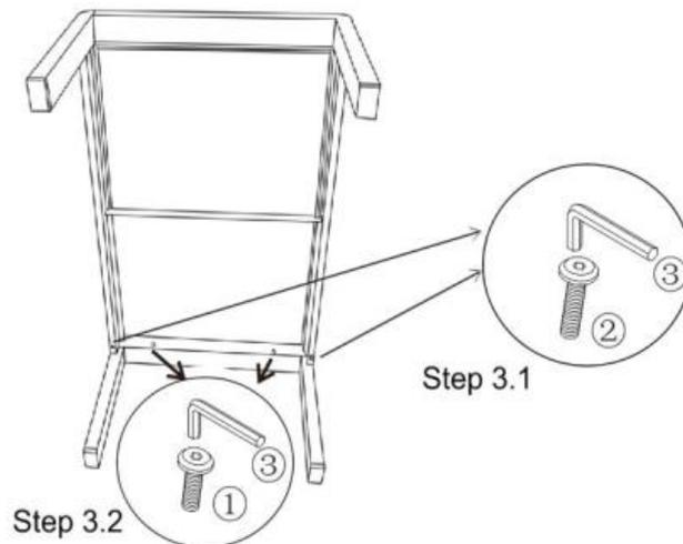
3.1 Attacher Cadre Supérieur Table(C) au Jambe Droite(B) en utilisant les Boulons (②) avec l'aide du Clef(③) comme montre l'image au dessus.
