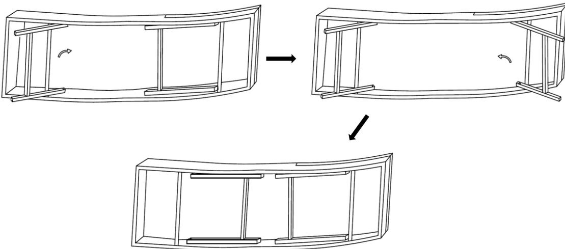
Afin de fermer, veuillez fermer d'abord la jambe sous le siège, et ensuite l'autre jambe sous le dos, à la main.
