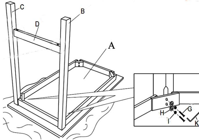
Fixez la jambe gauche de table (B) et la jambe droite de table (C) sur le dessus de table (A), à l'aide de l'anneau de rondelle plate (H), de l'anneau de rondelle à ressort (I) et du boulon JCBC (G), serrez le boulon JCBC avec la clé Allen (J). )
