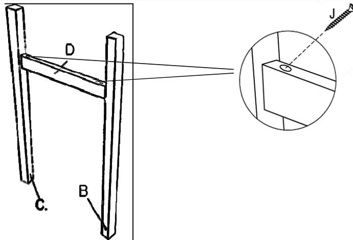
Alignez le rail de support court de table (D) sur la jambe gauche de table (B) et la jambe droite de table (C), serrez avec la vis (J), connectez l'autre côté du rail de support de table (D), la jambe gauche de table (B) et la jambe droite de table (C) avec le même processus.
