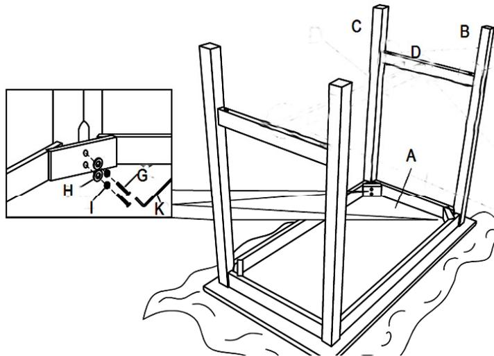
Préparez l'autre côté de la jambe gauche de table (B) et de la jambe droite de table (C) et du rail de support court de table (D), fixez la jambe gauche de table (B) et la jambe droite de table (C) au dessus de table (A), à l'aide de l'anneau de rondelle plate (H), bague de rondelle à ressort (I) et boulon JCBC (G), serrez le boulon JCBC avec la clé Allen (J)
