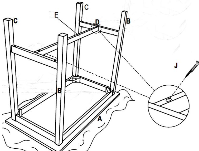
Fixez le long rail de support de table (E) des deux côtés du rail de support court de table à l'aide de la vis (J).
