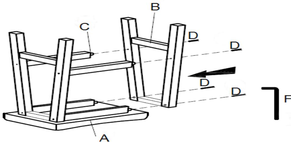
Faites glisser le cadre de jambe (B) dans le bas des goujons et des rails de banc (C).
