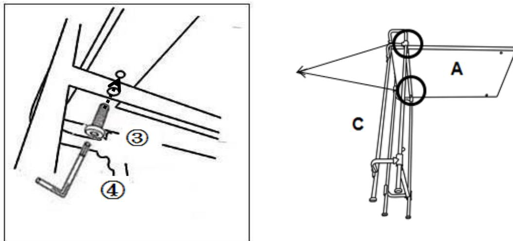
Ouvrez le carton et placez toutes les pièces sur une surface propre et non marquante. Placez le cadre de la jambe droite (C) sur son côté, comme illustré. Fixez le plateau en bois supérieur (A) au cadre de la jambe droite (C) à l'aide de boulons (3) avec une clé Allen (4).
