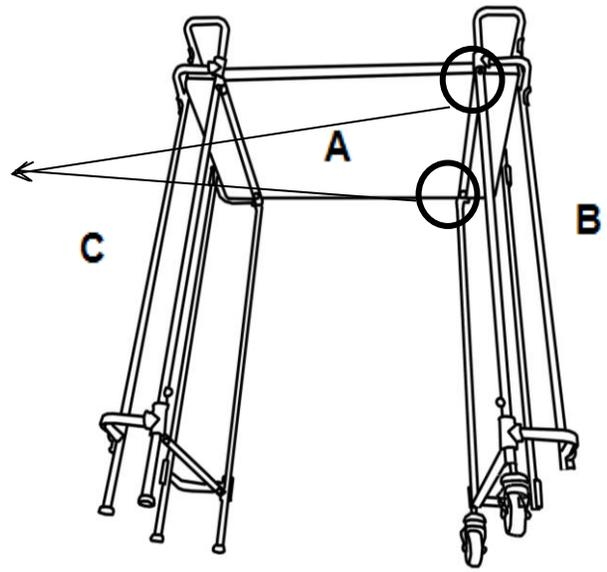
Fixez le plateau en bois (A) au cadre de la jambe gauche (B) à l'aide de boulons (③) avec une clé Allen (④).
