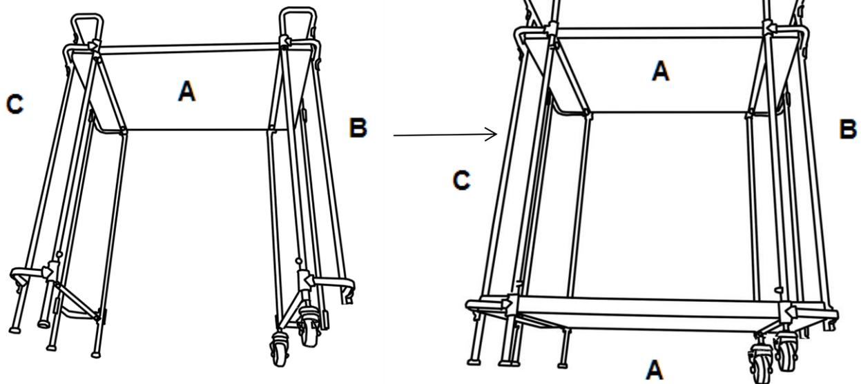
Fixez le plateau en bois inférieur (A) entre le cadre de la jambe droite (C) et le cadre de la jambe gauche (B) à l'aide de boulons (③) avec une clé Allen (④).
