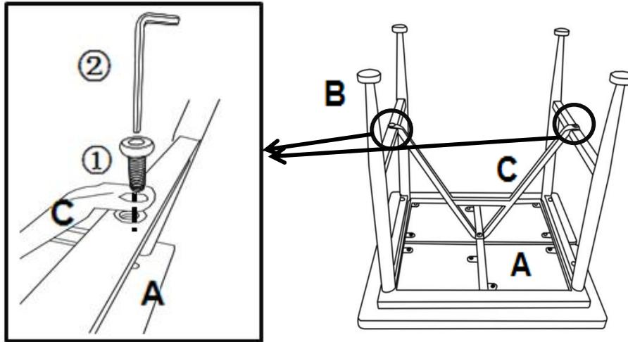
Fixez le support en forme de «V» (C) dans les jambes (B) à l'aide des boulons (①) avec la clé Allen (②) comme illustré.
