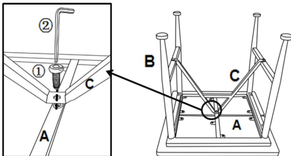
Fixez le support en forme de «V» (C) dans le dessus de table (A) à l'aide des boulons (①) avec la clé Allen (②) comme illustré.
