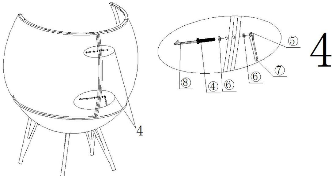
Fixez le panneau latéral central droit (G) au panneau latéral central gauche (F) avec la clé Allen (⑧) et la clé (⑦), en utilisant les boulons (④), les rondelles (⑥) et les écrous (⑤).
