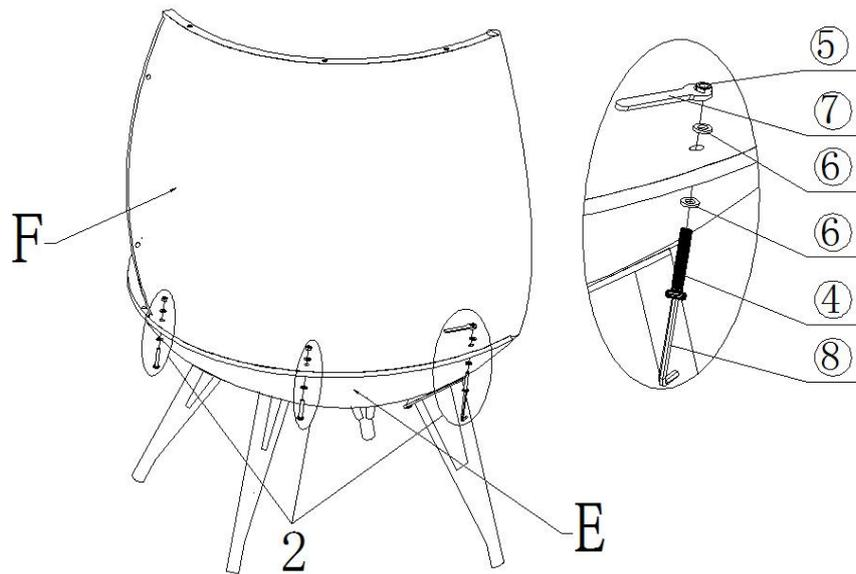
Tenez le siège de panier (E) à la verticale. Fixez le panneau latéral central gauche (F) au siège du panier (E) à l'aide de la clé Allen (⑧) et de la clé (⑦), en utilisant les boulons (④), les rondelles (⑥) et les écrous. (⑤).
