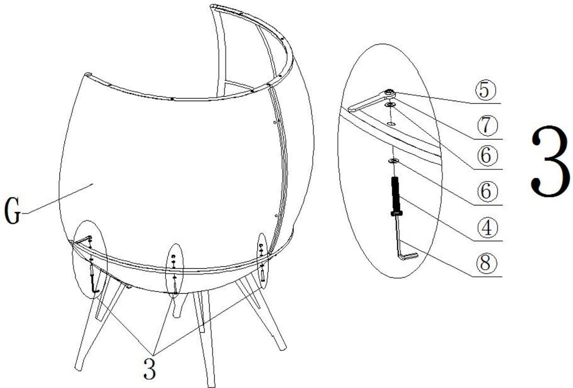
Fixez le panneau latéral central droit(G) au siège de panier (E) avec la clé Allen (⑧) et la clé (⑦), en utilisant les boulons (④), les rondelles (⑥) et les écrous (⑤).
