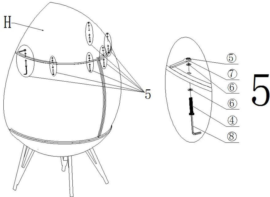
Fixez le dessus de panier (H) au panneau latéral central droit (G) et au panneau latéral central gauche (F) à l'aide de la clé Allen (⑧) et de la clé (⑦), à l'aide des boulons (④), des rondelles (⑥) et des écrous (⑤).
